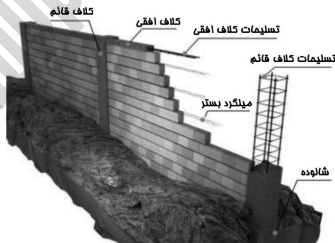
شکل ۱-۲ قسمت‌های اصلی دیوارهای محوطه بنایی (ص ۱۸)
